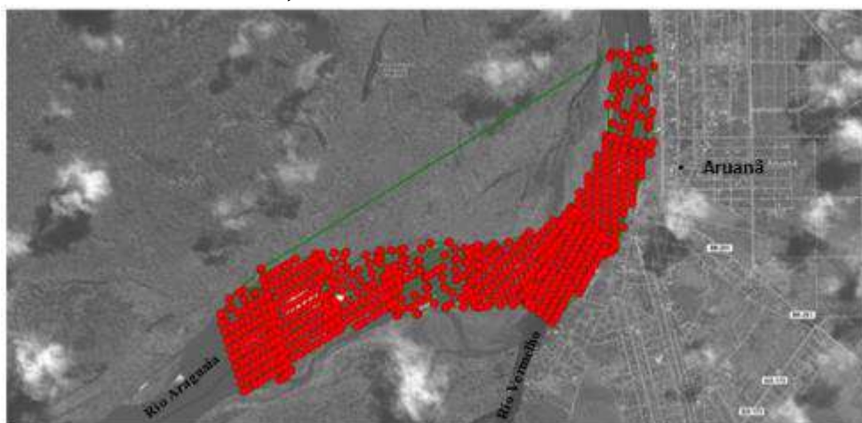
Figura 04 - Fototriangulação e alinhamento das imagens para o processamento inicial, com referência à área de estudo
