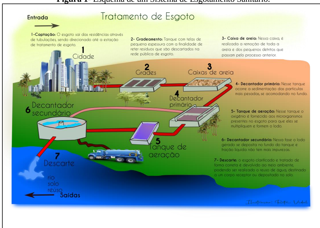
Figura 1- Esquema de um Sistema de Esgotamento Sanitário.
