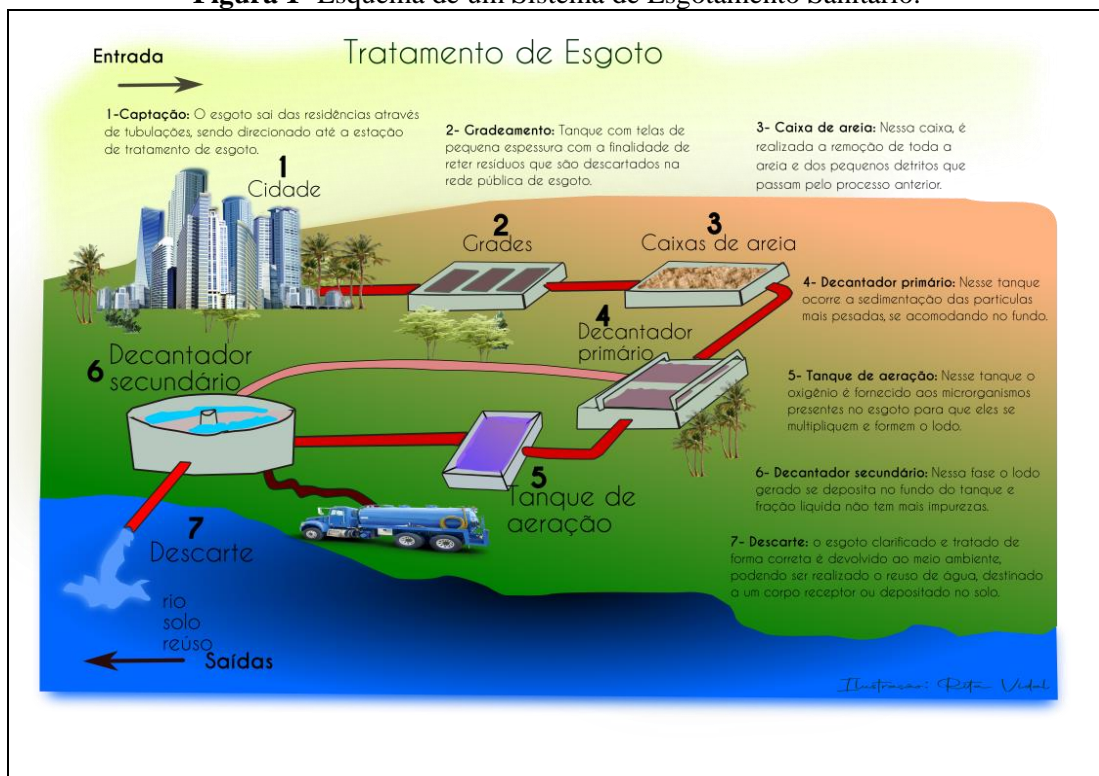
Figura 1- Esquema de um Sistema de Esgotamento Sanitário.
