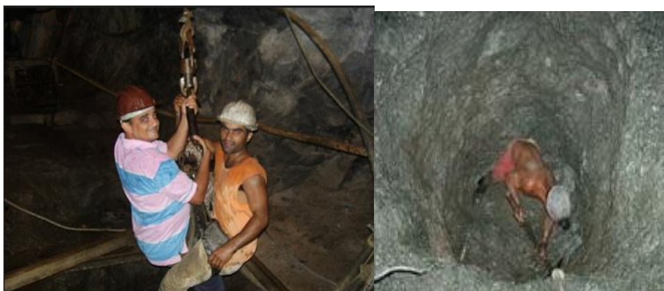
Figura 01: Gancho improvisado, falta de segurança e insalubridade dentro das catas
